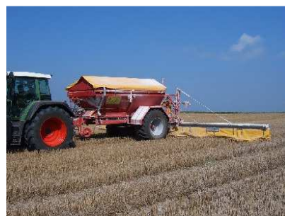
Kohlensaurer Kalk 95 trocken bei der Ausbringung mit leistungsfähigen Schneckenstreuern
