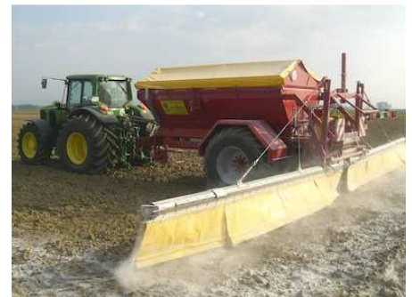
Moderner Schneckenstreuer mit 12 Meter Streuschnecke
